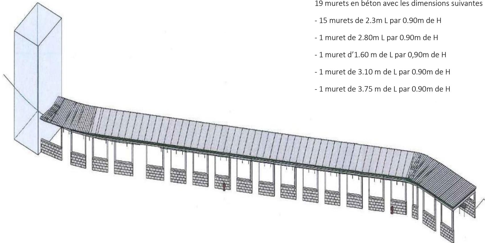
19 murets en béton avec les dimensions suivantes :
